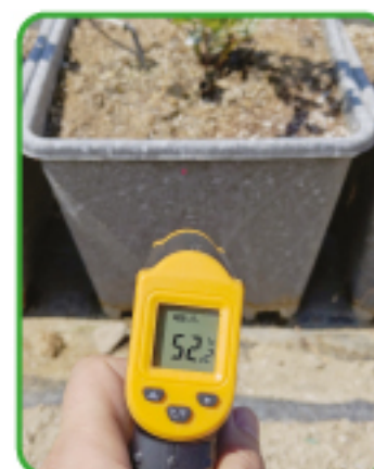
Temperatura de la maceta sin falda de enfriamiento.
