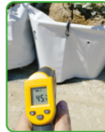
Temperatura de la maceta con falda de enfriamiento.
