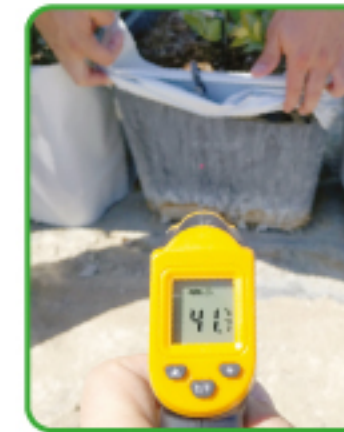
Temperatura de la maceta con falda de enfriamiento levantada
